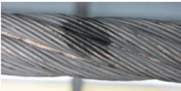
Abbildung 6.4: Blitzschlag 1,5 x Litzendurchmesser
