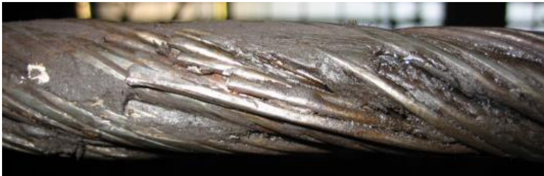
Abbildung 11: Verschmutztes Seil – Inspektion nicht möglich
