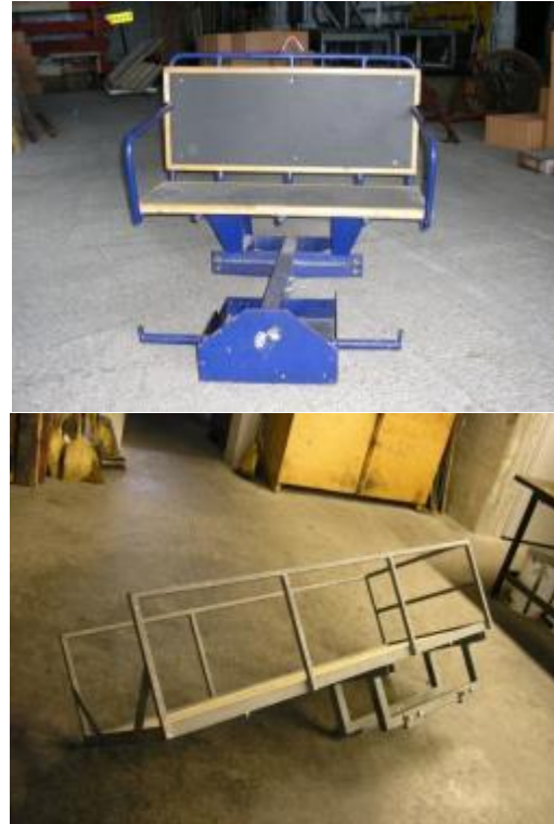
Abbildung 5.6: Vorrichtungen zur visuellen Seilinspektion
