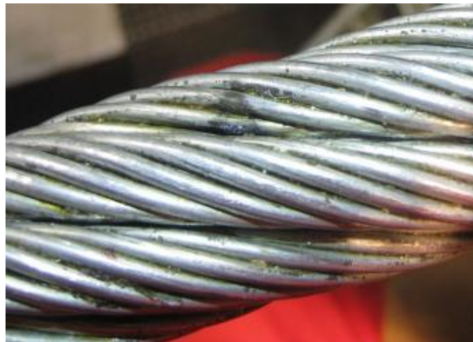
Abbildung 6.1: Blitzschlag bläulich verfärbt
