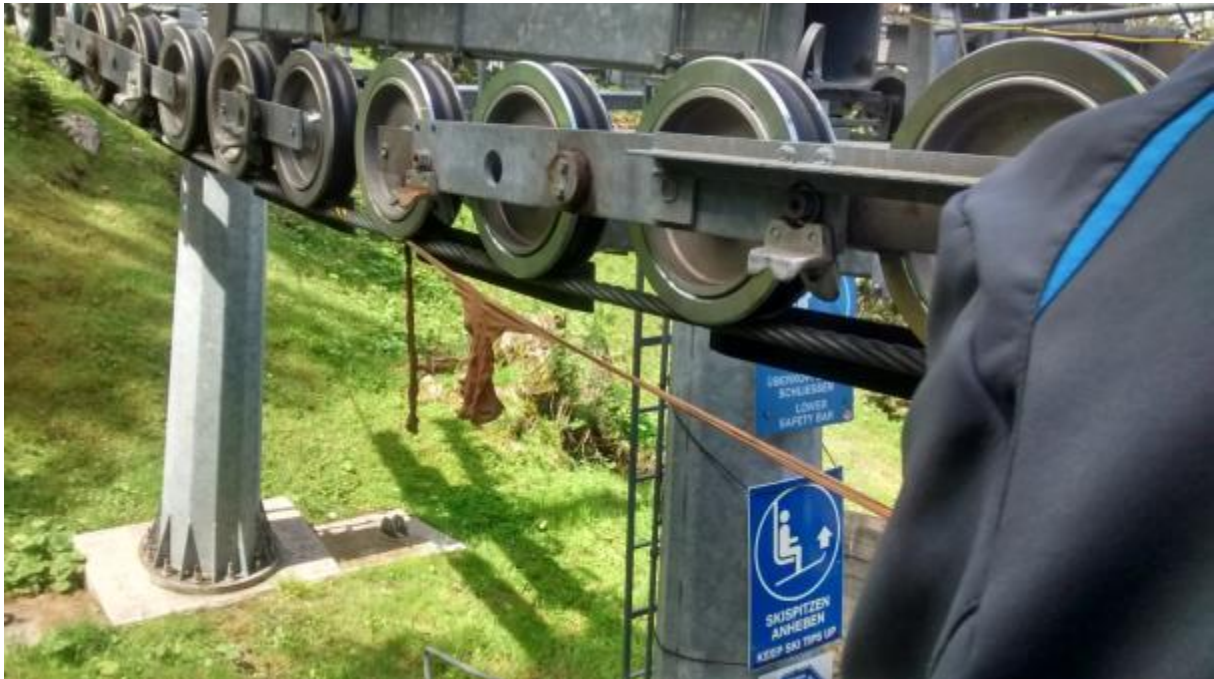
Abbildung 7.19: Strumpf, der am Seil hängen bleibt und unter die Rollen geraten ist
