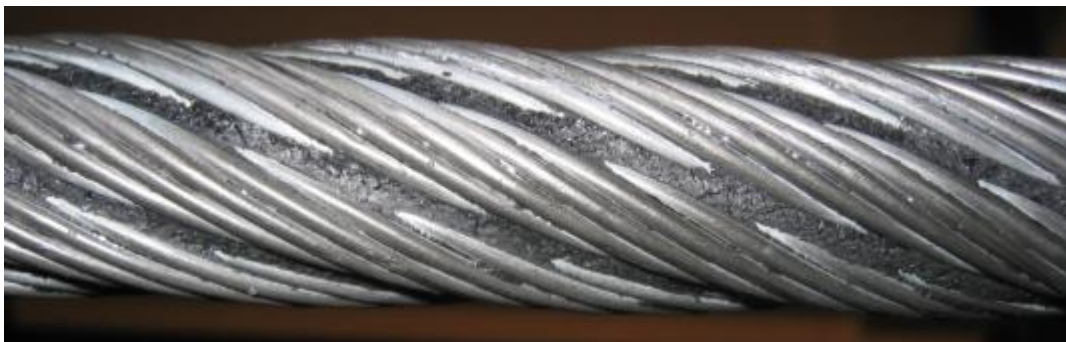
Abbildung 8.14: Schmutz in Litzengassen – schwer zu inspizieren
