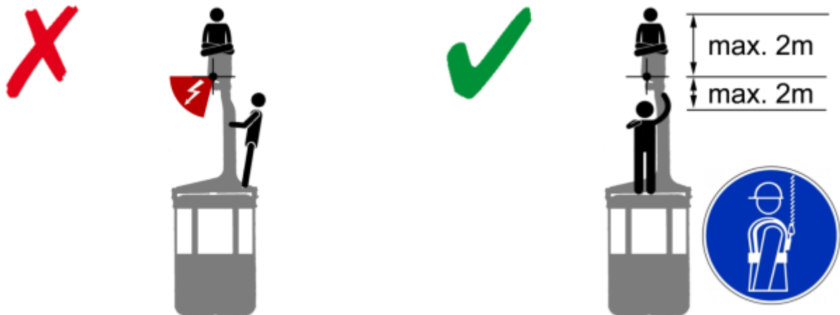
Abbildung 8.11: Schlechte Positionierung bei der Tragseilinspektion. Ca. 45 ° des Seiles sind nicht einsehbar.
