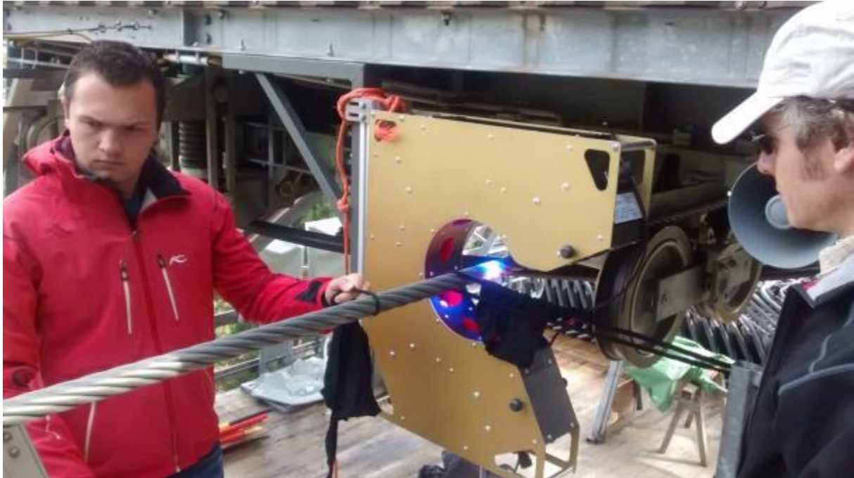
Abbildung 7.18: Inspektion mit Nylonstrumpf
