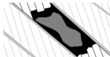
Abbildung 6.12: Bruch komplette Litze abstrahiert
