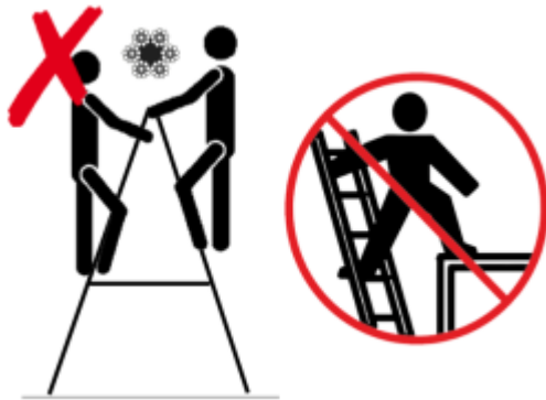
Abbildung 9: Nicht empfohlene Verwendung einer Leiter
