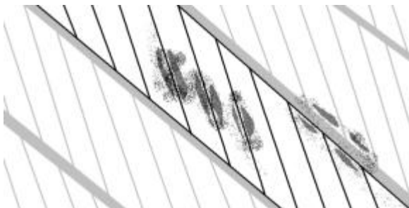
Abbildung 6.19: Korrosion in Litzengasse abstrahiert
