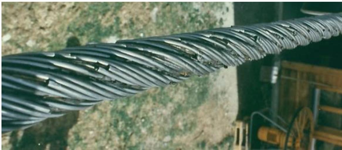
Abbildung 4.2: Schäden von gerutschter Klemmplatte
