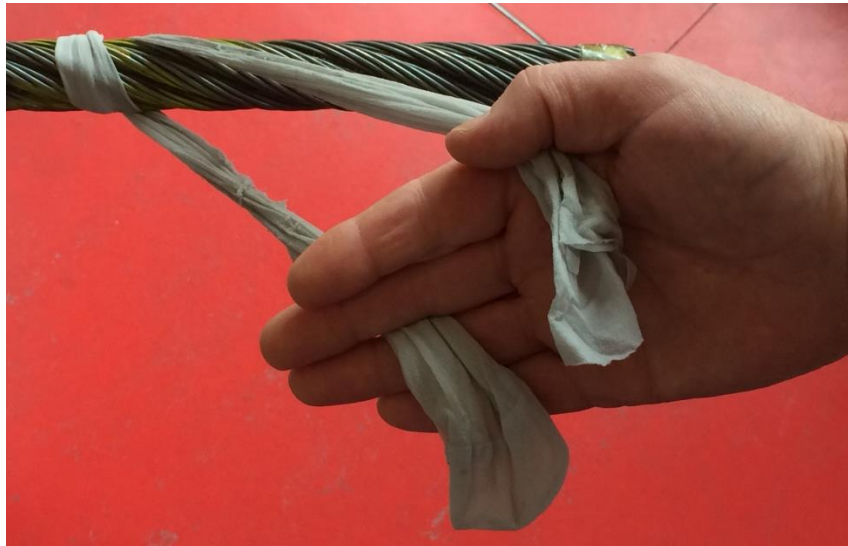
Abbildung 7.20: Sicheres Halten eines Nylonstumpfes
