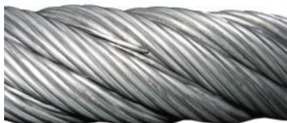
Abbildung 6.9: Drahtbruch mit abstehendem Draht
