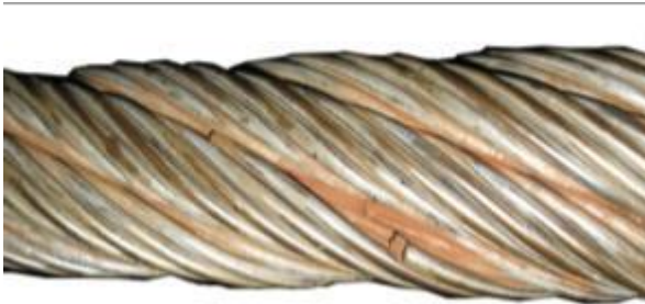
Abbildung 6.17: Litzengassenkorrosion (mit Drahtbrüchen)
