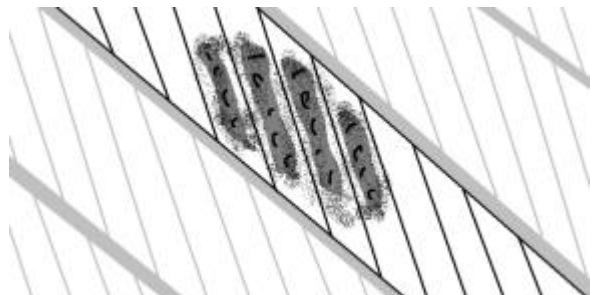
Abbildung 6.20: Korrosion über mehrere Litzen abstrahiert
