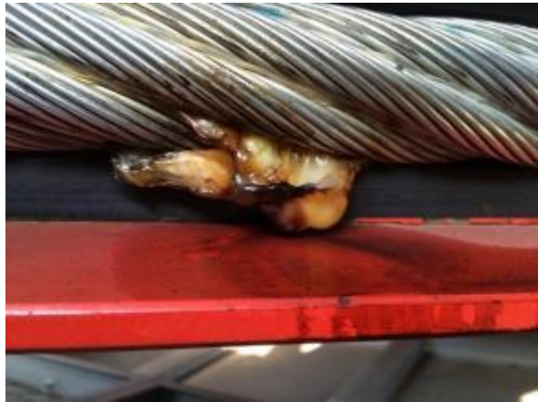
Abbildung 4.7: Schaden durch Stromfluss
