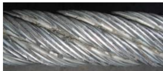
Abbildung 6.26: Riefen auf einem Zugseil
