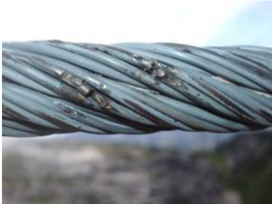
Abbildung 6.2: Martensitstrukturen mit geschmolzenen Drähten
