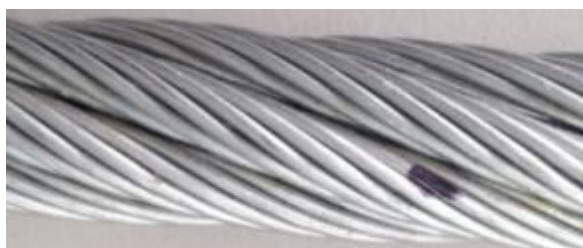
Abbildung 6.13: Einzeldrahtbruch in Litzengasse
