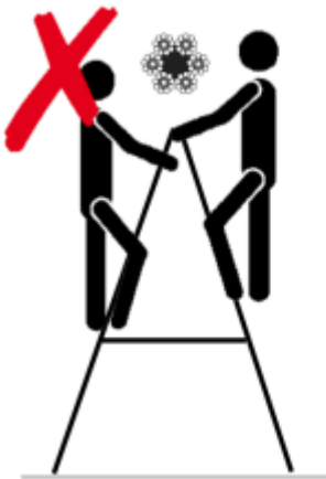
Abbildung 8.9: Nicht empfohlene Verwendung einer Leiter
