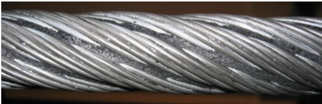
Abbildung 12: Schmutz in Litzengassen – schwer zu inspizieren
